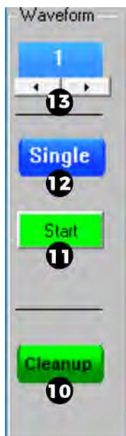
Per iniziare la procedura, premere il pulsante **"Start" (11)**. Una barra di scorrimento di colore giallo indicherà l'avvio e la conclusione dell'acquisizione dei segnali in tempo reale. Al termine, il grafico dei segnali ricevuti generati dai sensori sarà visualizzato nella finestra dell'oscilloscopio. Se la barra di scorrimento si blocca e diventa rossa, segnalando un errore di comunicazione, ripetere l'operazione.
