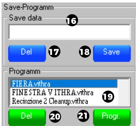
Un file di programmazione effettuata in un'unità di analisi può essere utilizzato per programmare altre unità. Per salvare la configurazione effettuata, descrivere l'etichetta nella finestra **"Save Data" (16)** e premere il pulsante **"Save" (18)**. Utilizzare il pulsante **"Del" (17)** per correggere la descrizione inserita, se necessario. La denominazione della configurazione salvata sarà visualizzata nella finestra **"Programm" (19)**.
